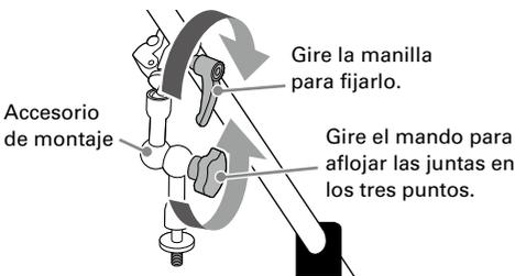
2. Acople el accesorio de montaje al **V3**.
