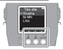
Ajuste correctamente el tipo de pila usada de cara a que pueda ser mostrado con precisión el nivel de carga restante de la pila.
