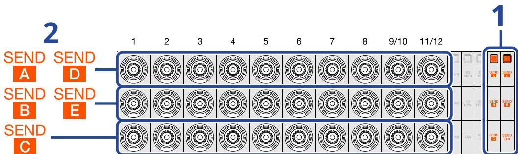
1. Pulse  SEND A /  SEND B /  SEND C (botón de selección del mando de canal 4) o  SEND D /  SEND E /  SEND EFX (botón de selección del mando de canal 5).
