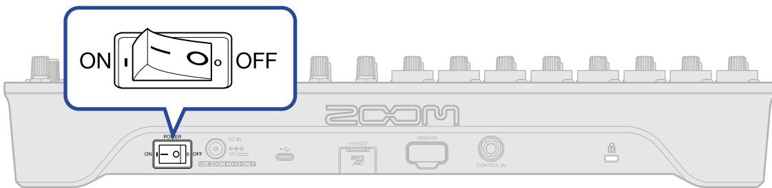
**3.** Conecte el cable de un adaptador de corriente específico (AD-19) a la toma DC IN 12V y conecte el adaptador a una salida de corriente alterna.
