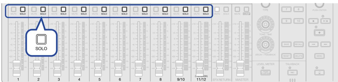
La toma MONITOR OUT (PHONES) se ajustará automáticamente a "SOLO" y la señal pre-fader del canal seleccionado será emitida por esa toma. (→ [Ajustes de la toma MONITOR OUT \(PHONES\)](#))
