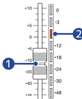
**1** Posición del fader de canal
