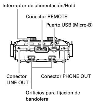
Si se conecta un ZOOM BTA-1 u otro adaptador inalámbrico dedicado al conector REMOTE y se usa la aplicación del controlador dedicado, el **H8** se puede controlar desde un dispositivo iOS/iPadOS.
