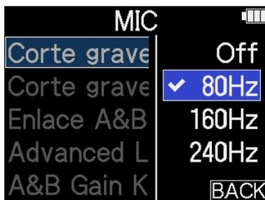
Puede ajustar este Corte graves a OFF, 80 Hz, 160 Hz o 240 Hz.
