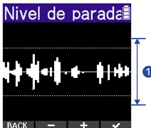
La grabación se detendrá automáticamente en cuanto la señal de entrada quede por debajo del nivel establecido durante el tiempo ajustado en el paso 5.
