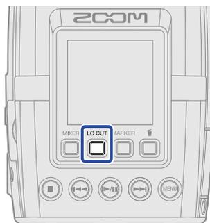
Puede elegir y ajustar la frecuencia de corte a OFF, 80 Hz, 160 Hz o 240 Hz.
