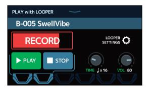
Podrá realizar ajustes del looper e iniciar y detener grabaciones y reproducciones a través de la pantalla táctil y los pedales.
