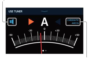
Esto muestra el tipo de afinador y el tono standard. Toque aquí para cambiar los ajustes del afinador. ( $\rightarrow$  "Cambio de los ajustes del afinador" en pág. 58)
