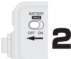
Para usar la alimentación por bus USB, ajuste el interruptor BATTERY a OFF.
