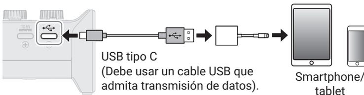
Para conectar smartphones y tablets, deberá usar los cables y adaptadores USB necesarios para cada tipo de conector.
