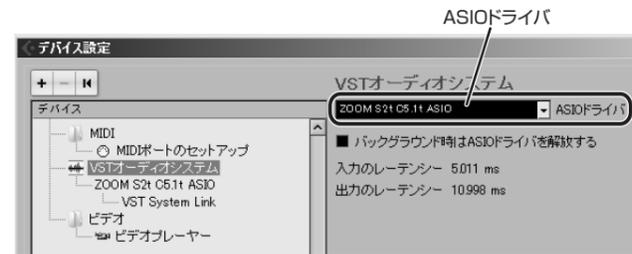
ウィンドウ左側のデバイスの列には、選択されているASIOドライバ “ZOOM S2t C5.1t ASIO” が表示されます。これをクリックして選び、デバイス設定ウィンドウの右部に表示される “コントロールパネル” ボタンをクリックしてください。
