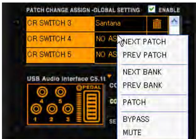
3. 表示された機能の中から“BYPASS”にカーソルを合わせてクリックしてください。
