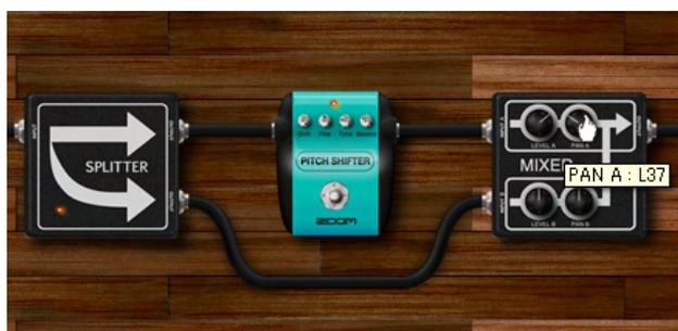
Aチャンネルの音の左右の定位が変更されます。左に回すとL側、右に回すとR側から音が聞こえてきます。[PAN B]ノブを回した場合は、Bチャンネルの音の左右の定位を変更することができます。
