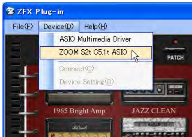
ASIOドライバーが変更されます。初期状態ではZOOM S2t C5.1t ASIOドライバーが選択されています。S2t/C5.1t以外のオーディオインターフェースを使用する場合、その製品に合ったASIOドライバーを選択してください。
