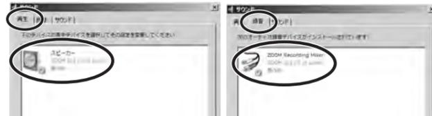
サウンドウィンドウでは、再生/録音デバイスに “ZOOM S2t C5.1t Audio” が表示され、チェックが入っていることを確認します (再生/録音の表示はウィンドウ上部のタブで切り替えます)。チェックが入っていない場合は、デバイスを表すアイコンを右クリックして、表示されるメニューの“既定のデバイスとして設定” にチェックを入れます。
