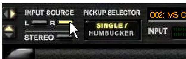
3. 楽器などがCH1/L端子、CH2/R端子の両方にステレオ入力されている場合は、INPUT SOURCE[STEREO]ボタンをクリックします。
