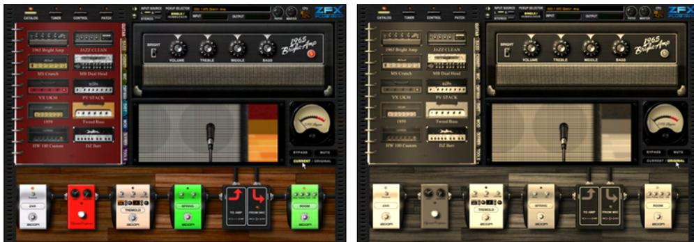
上の図のように、オリジナル状態の画面はセピア色で表示され、音色もパッチをエディットする前の音色（パッチ選択直後）になります。また、画面の入れ替わりに応じて [CURRENT/ORIGINAL] ボタンの文字の点灯する位置も変化します。
