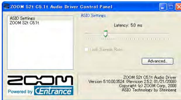
ドライバーのコントロールパネルには、レイテンシーを調節するスライダーがあります。お使いのコンピュータで、音声が途切れない範囲でもっとも低い値に設定してください。もし、音声が途切れるようであれば、値を増やしてください。この値はお使いのコンピュータによって異なります。コンピュータの性能が高ければ、低い値に設定し低いレイテンシーで動作させることができます。コンピュータの性能が低い場合は、高めの値に設定すると動作が安定します。設定を行う項目は選択されたASIOドライバーの種類によって異なります。
