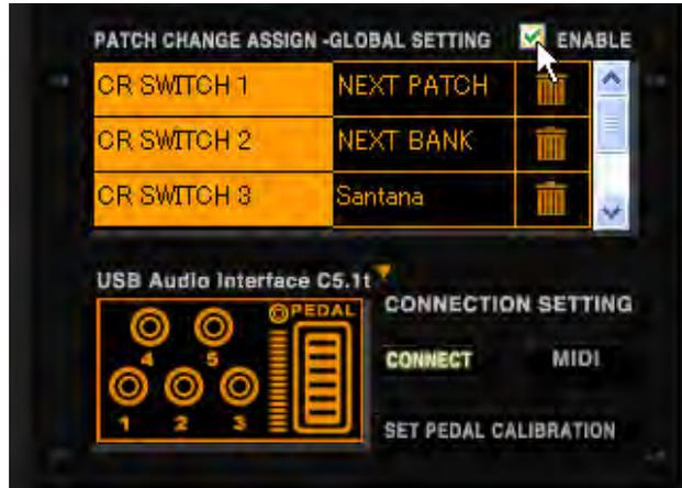
[GLOBAL SETTING] リストの内容が有効になります。一つのフットスイッチに対して、パッチチェンジなどの各種機能の操作とエフェクトパラメーターの操作の両方が割り当てられている場合、[GLOBAL SETTING] リストの操作が優先して行われます。
