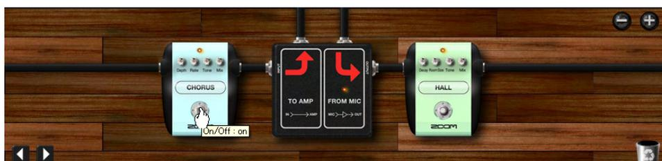
エフェクターをバイパスさせることができます。バイパスを解除するには、再度、エフェクターのフットスイッチをクリックします。
