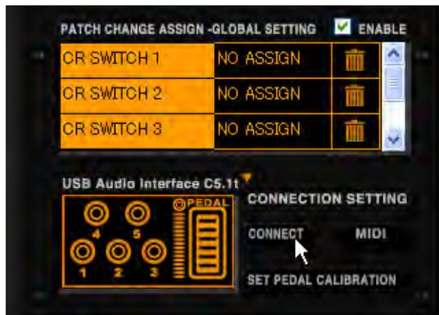
[CONNECT]ボタンが点灯して、エクスプレッションペダルやフットスイッチの操作がZFX Plug-inへと送られます。
