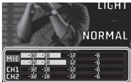
最も大きな音が入力された時、レベルメーターの表示が  $-12$  dB になるように調節します。
