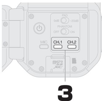
マイクを接続したチャンネルの  CH.1 /  CH.2 を押し
