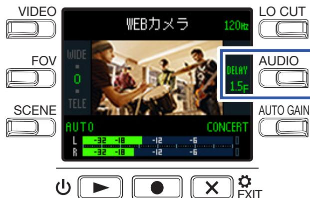
**DELAY**を押すたびに音声の遅延時間が長くなります。
