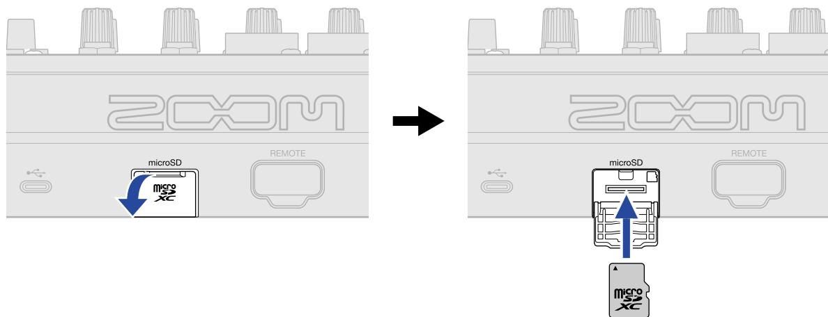
microSDカードを取り出すときは、microSDカードを一度スロットの奥に押し込んでから引き抜きます。
