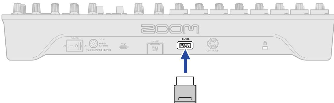
REMOTE端子のキャップを外して取り付けます。
