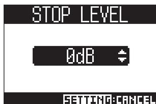
MASTER フェーダー通過後の信号が設定したレベルを下回り、手順 4 で設定した時間が経過したときに自動的に録音を終了します。
