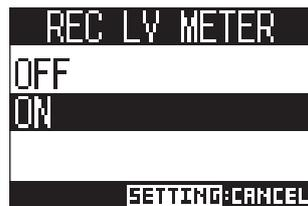
ポストフェーダーのレベルより、録音される信号レベルが大きいとき、録音される信号レベルがレベルメーター上に薄い色の点灯で表示されます。
