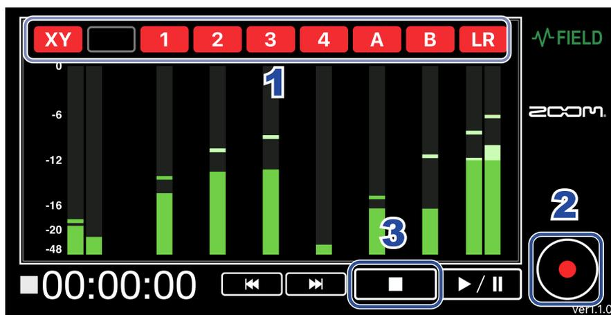
1. 録音したいトラックのトラックボタンをタップして赤色に点灯させる
