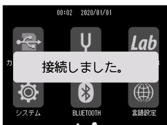
接続が開始されます。接続が完了すると、レコーダー本体のディスプレイに「接続しました」と表示されます。
