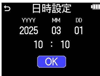
日時が確定し、電池の種類を設定する画面が表示されますので、電池の種類を設定してください。（→[電池の種類を選択する（初回起動時）](#)）
