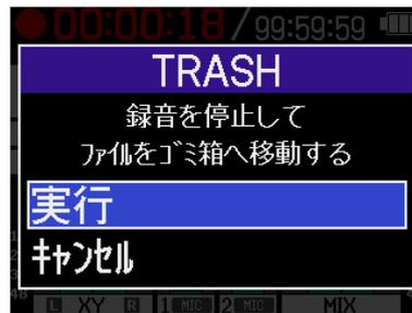
「キャンセル」を選択して
