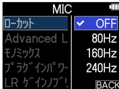
ローカットはOFF／80 Hz／160 Hz／240 Hzの内から選択して設定できます。
