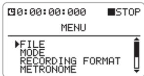
**2. ジョグダイヤルを上下操作してカーソルを“RECORDING FORMAT”に合わせ、ジョグダイヤルを押し込んでください。**
