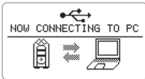
この画面が表示された時点で、パソコンとH4がオンライン状態になり、パソコンがH4を外部記憶装置として認識して、SDカードの操作が可能になります。必要に応じて、パソコン側からファイルのコピーや削除を行ってください。
