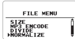
3. ジョグダイヤルを上下操作してカーソルを“NORMALIZE”に合わせ、ジョグダイヤルを押し込んでください。
