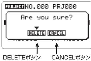
**3.** 削除を実行するには、ジョグダイヤルを上下操作してカーソルをDELETEボタンに合わせ、ジョグダイヤルを押し込んでください。
