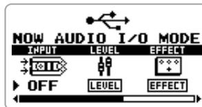
この状態で、入力信号の種類を選択できるようになりますので、ジョグダイヤルを上下操作して“OFF”（入力をオフ）にカーソルを合わせ、ジョグダイヤルを押し込みます。
