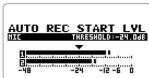
レベルメーターで入力信号を監視しながら、ジョグダイヤルを上下操作してスタートレベルを最適な値に設定してください。設定が終わったら、ジョグダイヤルを押し込むと、AUTO RECORDING画面に戻ります。
