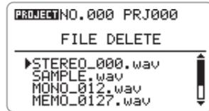
2. ジョグダイヤルを上下操作して削除したいファイルにカーソルを合わせ、ジョグダイヤルを押し込んでください。
