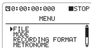
2. ジョグダイヤルを上下操作してカーソルを“MODE”に合わせ、ジョグダイヤルを押し込んでください。
