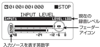
入力信号のレベルを表すメーターの左側に、現在選ばれている入力ソースを示す英数字が表示されます ([INPUT 1] / [INPUT 2] 端子は1と2、内蔵ステレオマイクはLとRで表示されます)。また、録音レベルを調節したいトラックにカーソルを合わせ、ジョグダイヤルを押し込めば、メーター部分にフェーダーアイコンが表示され、録音レベルの調節が行えるようになります。このアイコンが表示されている間、カーソルは表示されません。
