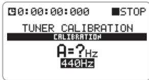
② ジョグダイヤルを上下操作して基準ピッチを変更します。
