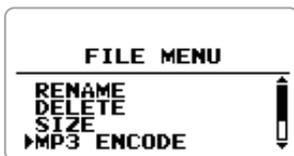
3. ジョグダイヤルを上下操作してカーソルを“MP3 ENCODE”に合わせ、ジョグダイヤルを押し込んでください。
