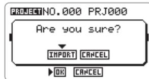
**6.** 取り込みを実行するには、カーソルをIMPORTボタンに合わせ、ジョグダイヤルを押し込んでください。取り込みが実行され、ディスプレイに“Complete!”が表示されます。
