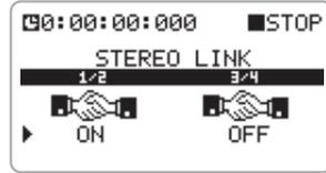
3. ジョグダイヤルを上下操作して、カーソルを1／2（トラック1／2）または3／4（トラック3／4）の項目に合わせ、ジョグダイヤルを押し込んでください。
