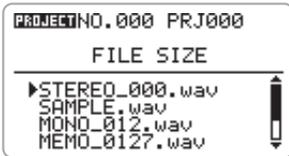
2. ジョグダイヤルを上下操作して容量を確認したいファイルにカーソルを合わせ、ジョグダイヤルを押し込んでください。
