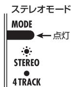
[MODE]インジケーターが消灯しているときは、H4が4トラックモードに設定されています。ステレオモードに切り替えてください(→P30)。
