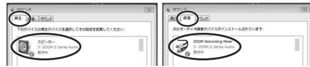
サウンドウィンドウでは、再生/録音デバイスに“ZOOM G Series Audio”が表示され、チェックが入っていることを確認します(再生/録音の表示はウィンドウ上部のタブで切り替えます)。チェックが入っていない場合は、デバイスを表すアイコンを右クリックして、表示されるメニューの“既定のデバイスとして設定”にチェックを入れます。
