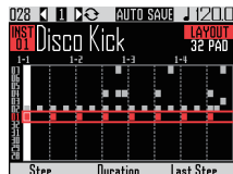
Step 設定を 1/32 もしくは 1/16Tri にした時の LCD 画面
