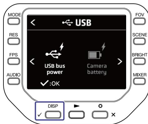
9. Collegate un computer o dispositivo iOS/iPadOS tramite un cavo USB.
