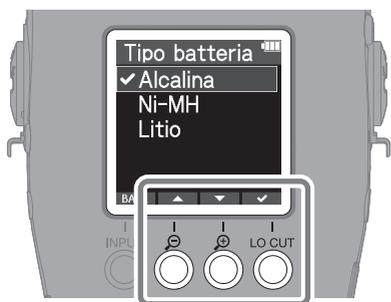
Impostate correttamente il tipo di batteria in uso, in modo che la carica residua sia visualizzata con precisione.
