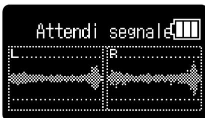
La registrazione si avvia in automatico quando il livello in ingresso impostato al punto 5 viene superato. La schermata di registrazione appare dopo che è stato visualizzato il nome del file in registrazione. (→ [Registrazione](#))
