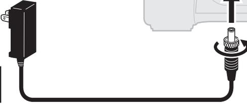
Serrez jusqu'à ce que le verrouillage à vis ne puisse plus être tourné. L'alimentation ne sera pas fournie si ce dispositif n'est pas complètement serré.
