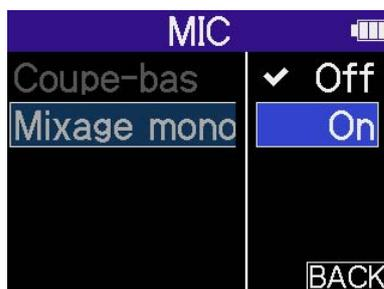
Lorsque « On » est sélectionné, l'entrée par la capsule micro devient mono.
