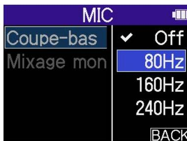
Le filtre Coupe-bas peut être réglé sur OFF, 80 Hz, 160 Hz ou 240 Hz.
