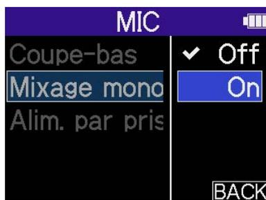
Lorsque « On » est sélectionné, l'entrée par le micro XY intégré devient mono.
