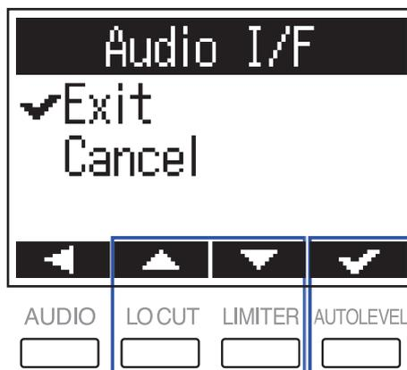
Cela met fin au fonctionnement comme interface audio et rouvre l'écran d'enregistrement.
