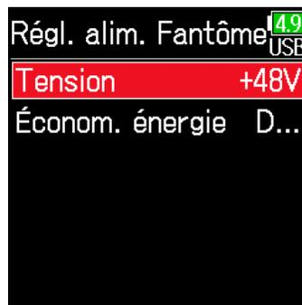
5. Avec ▲ et ▼, sélectionnez la tension, et pressez ✓.
