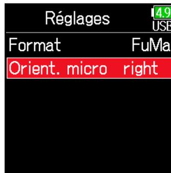
7. Avec ▲ et ▼, sélectionnez l'orientation du micro et pressez ✓.
