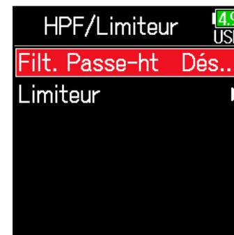
7. Avec ▲ et ▼, sélectionnez la fréquence de coupure désirée, et pressez ✓.
