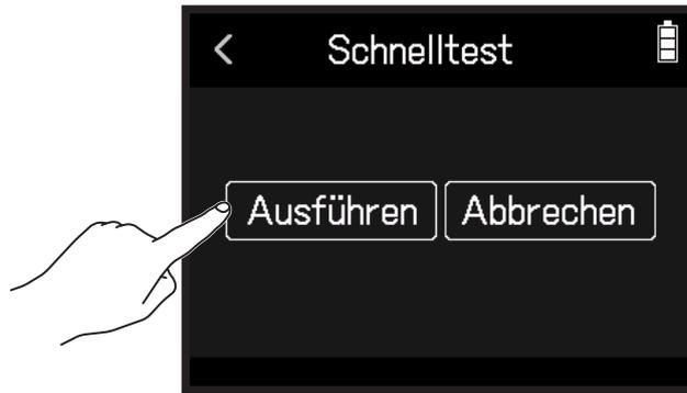
Der Leistungstest für die Karte startet und dauert etwa 30 Sekunden. Zum Abschluss wird das Testergebnis eingeblendet.
