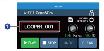
1 Wenn die Loop-Aufnahme startet, wird der Loop-Name dargestellt. Der erzeugte Loop wird mit dem dargestellten Namen gespeichert.
