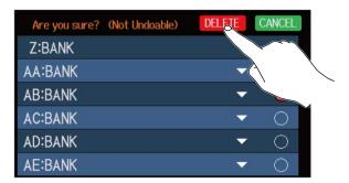
Dadurch wird diese Bank gelöscht und die folgenden Bänke werden nach oben verschoben.
