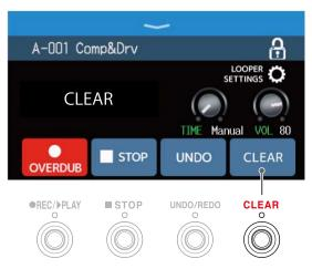
Dadurch wird der aufgenommene Loop gelöscht.
