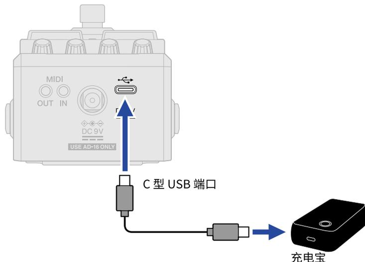
MS-90LP+ 将在连接充电宝后开启电源。
