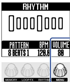
该操作用于调节乐句记忆中节奏的音量。如果您想调节 MS-90LP+ 的整体音量，请参阅“[调节整体输出电平 \(OUTPUT VOLUME\)](#)”。
