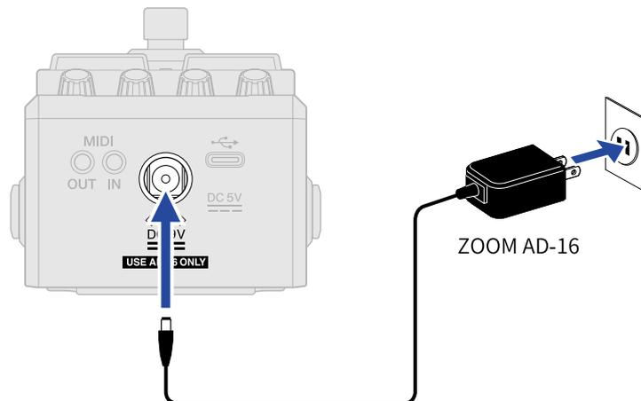
MS-90LP+ 将在连接 AC 适配器后开启电源。
