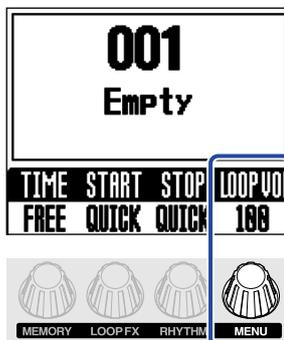
该操作用于调节乐句记忆的音量。如果您想调节 MS-90LP+ 的整体音量，请参阅“[调节整体输出电平 \(OUTPUT VOLUME\)](#)”。
