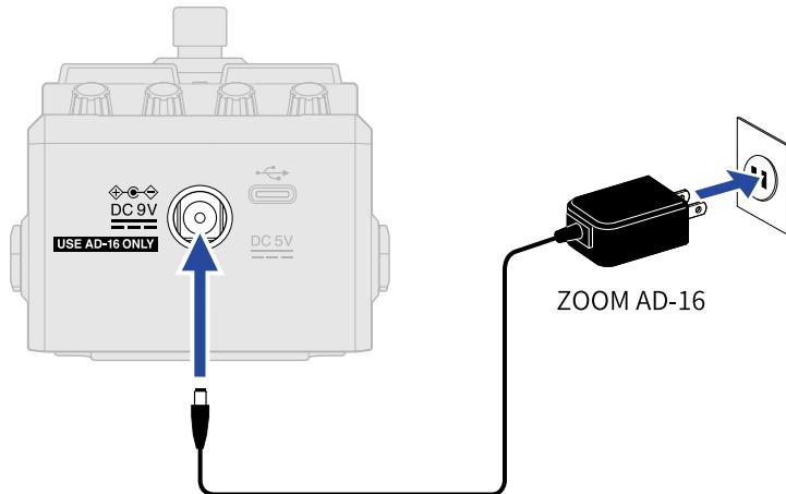
MS-70CDR+ 将在连接 AC 适配器后开启电源。
