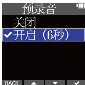
预录音 (开启时的) 时间取决于采样率设置 (→ [设置采样率](#))。
