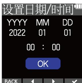
确认日期和时间设置后，屏幕将显示电池类型设置界面，请设置您所使用的电池类型。(→ [设置所使用的电池类型 \(首次开机\)](#))
