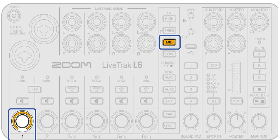
9. 请使用通道 1 (转轮旋钮) 设置自动关机。
