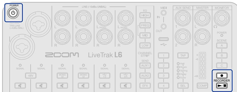
1. 请关闭设备电源，然后装入 microSD 卡。（→ [装入 microSD 卡](#)）
