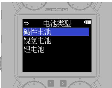
为了准确显示电池的剩余电量，请正确设置所使用的电池类型。
