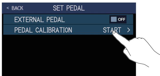
3. 请将表情踏板后端完全踩下 (表情踏板前端位于最高位置), 然后点击 OK。
