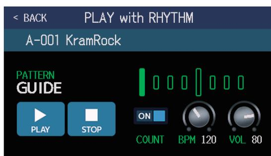
通过触摸屏和参数旋钮操作，您可以播放、停止和设置节奏。
