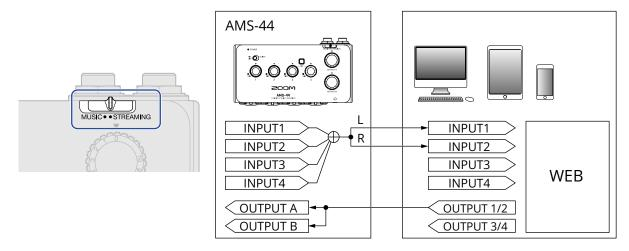
当您开启 AMS-44 的立体声链接时,INPUT 3 (左通道) 和 INPUT 4 (右通道) 将作为立体声输入。
