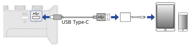
连接智能手机和平板电脑时,您需使用 USB 数据线和匹配接口的转换器。请使用支持数据传输的 USB 连接线。
