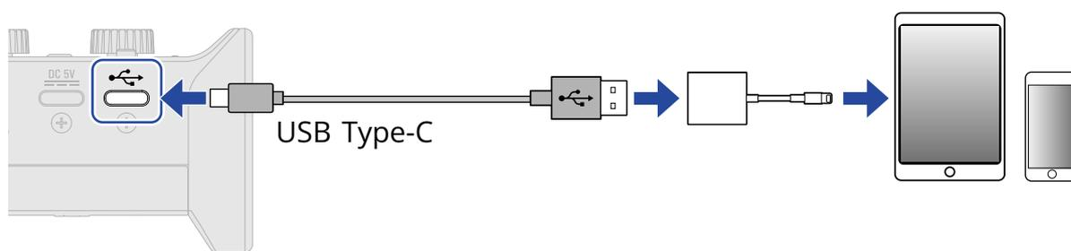
连接智能手机和平板电脑时，您需使用 USB 数据线和匹配接口的转换器。
