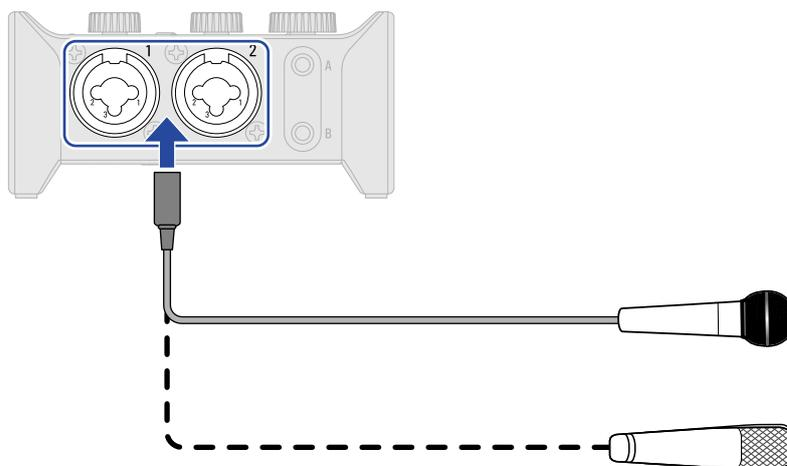
2. 当您话筒连接至 INPUT 1 接口时，请将
