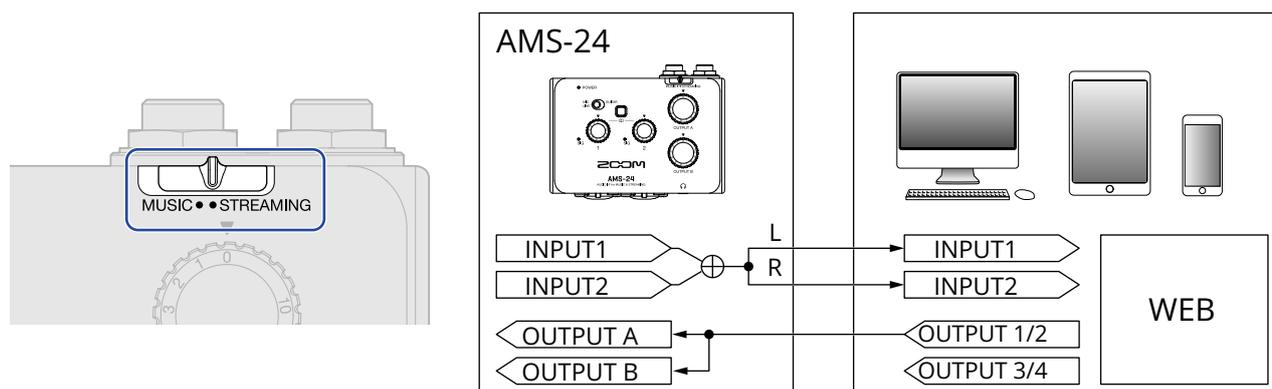
当您开启 AMS-24 的立体声链接时，INPUT 1 (左通道) 和 INPUT 2 (右通道) 将作为立体声输入。
