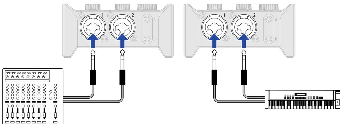
**2.** 请根据 INPUT 1 接口所连接的设备切换
