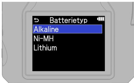
Stellen Sie den benutzten Batterietyp korrekt ein, damit die verbleibende Batteriekapazität exakt dargestellt werden kann.
