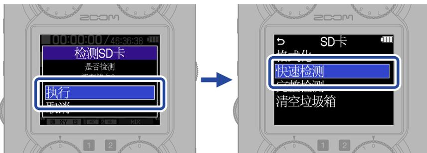
执行快速检测时，检测时间约 30 秒且忽略 microSD 卡的存储容量。执行完整检测时，检测时间取决于 microSD 卡的存储容量（64 GB 存储卡的检测时间约为 1.5 小时）。
