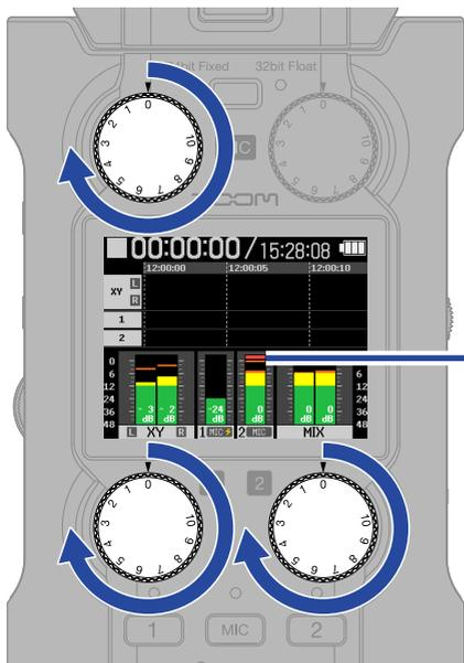
请确认电平表随电平变化而波动。
