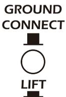
Die Buchse **BALANCED OUT** lässt sich von der Masse entkoppeln.
