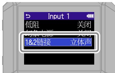
开启立体声链接时，音轨数据将录制为立体声文件，即音轨 1 为左声道，音轨 2 为右声道。
