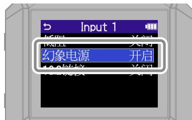
请为连接电容话筒的输入通道开启幻象电源。
