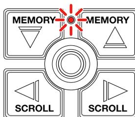
設定したテンポの間隔でインジケーターが点滅します。
