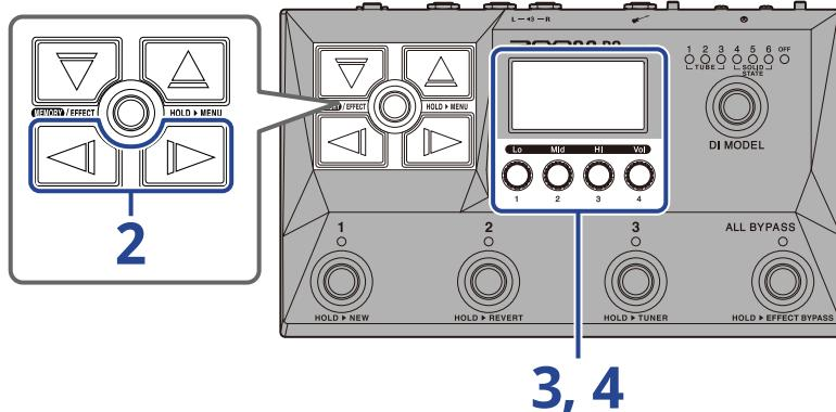
1. エフェクトのパラメーターを調節したいパッチメモリーのEFFECT画面を表示させる（→EFFECT画面を表示する）
