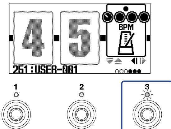
設定したテンポの間隔でインジケーターが点滅します。
