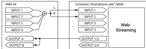
Wenn der Schalter Stereo Link am AMS-44 aktiv ist, arbeiten INPUT 3 (links) und INPUT 4 (rechts) als Stereo-Eingangspaar.
