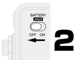
Per alimentare l'unità tramite USB bus, impostate l'interruttore BATTERY su OFF.
